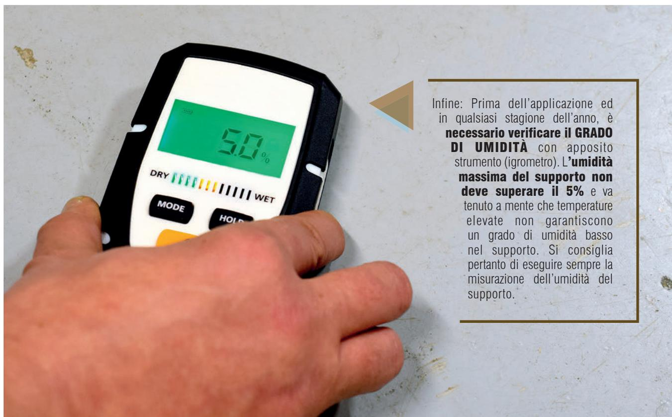
Infine: Prima dell'applicazione ed in qualsiasi stagione dell'anno, è **necessario verificare il GRADO DI UMIDITÀ** con apposito strumento (igrometro). L'**umidità massima del supporto non deve superare il 5%** e va tenuto a mente che temperature elevate non garantiscono un grado di umidità basso nel supporto. Si consiglia pertanto di eseguire sempre la misurazione dell'umidità del supporto.
