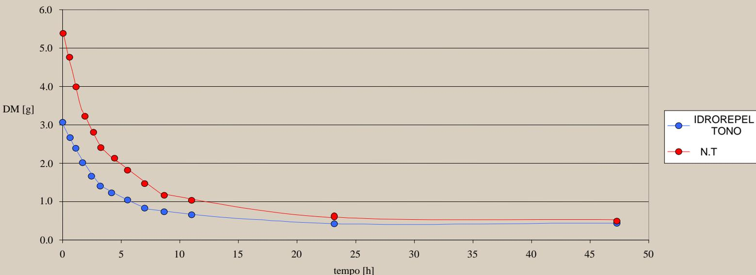
Si può quindi affermare che **il trattamento con IDROPEL TONO non fa mutare in maniera tangibile la capacità del substrato lapideo di perdere l'acqua eventualmente assorbita**, anche se tale fenomeno risulta leggermente rallentato nelle prime ore di evaporazione.
