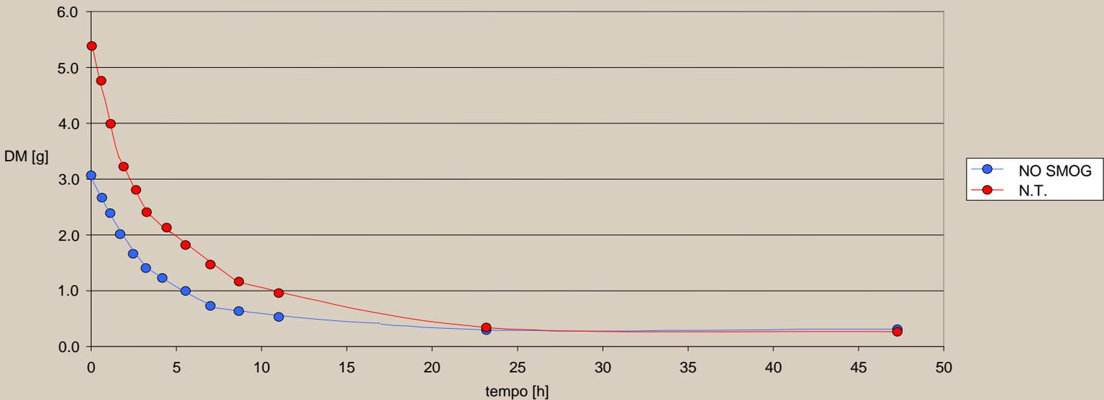
Si può affermare che **il trattamento con NO SMOG non fa mutare in maniera tangibile la capacità del substrato lapideo di perdere l'acqua eventualmente assorbita**, anche se tale fenomeno risulta leggermente rallentato nelle prime ore di evaporazione.
